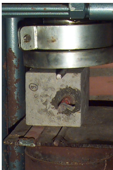
FIGURA 13: Rompimento do corpo-de-prova para a retirada da barra de aço.
