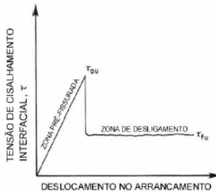
Figura 2.3 - Representação das tensões de cisalhamento na interface fibra-matriz após desligamento parcial da fibra (Bentur e Mindess, 1990).
