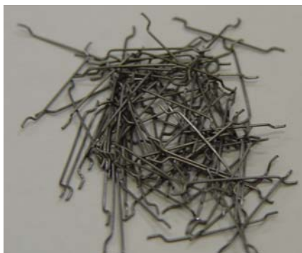
Figura 2.24 - Fibras de aço com extremidades deformadas, produzidas soltas.
