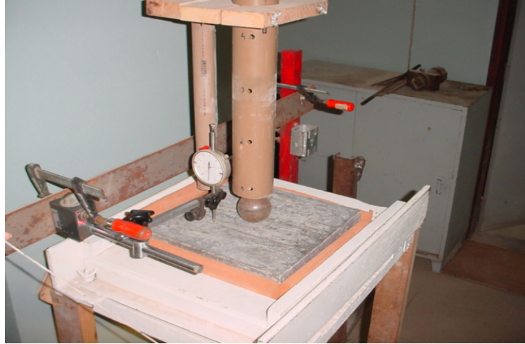
Figura 4.5 - Detalhe da placa de concreto no equipamento de ensaio de queda de esfera.
