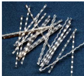
Figura 2.21 – Fibra sintética estrutural (Fitesa, 2004).
