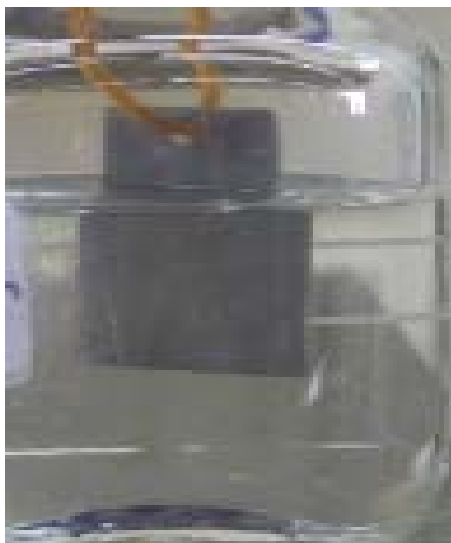
Figura 14 - Placa de aço-carbono imersa em etanol da Petrobrás após 15 dias de imersão, com adição de 100 mM de inibidor.
