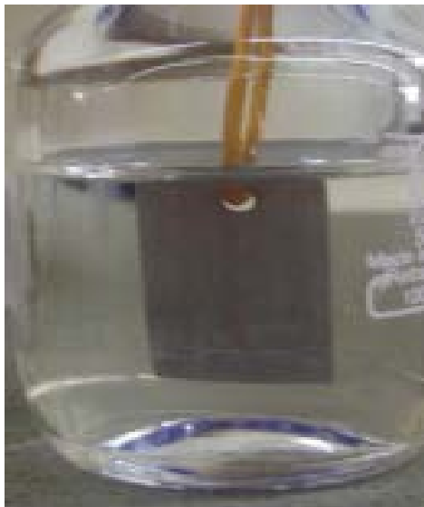
Figura 6 - Placa de aço-carbono imersa em etanol da Shell após 15 dias de imersão, com adição de 5 % de água + 100 mM de inibidor.
