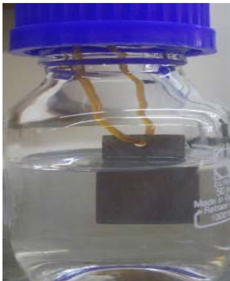
Figura 4 - Placa de aço-carbono imersa em etanol da Shell após 15 dias de imersão, com adição de 100 mM de inibidor.
