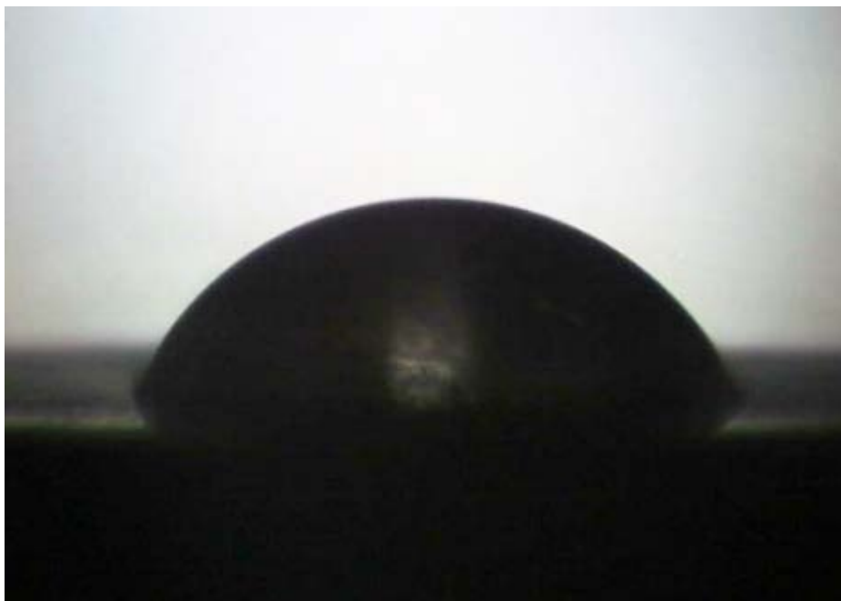
Figura 24 - Medida do ângulo de contato da Placa de aço-carbono após 15 dias de imersão em etanol da Shell, com adição 100 mM de inibidor.
