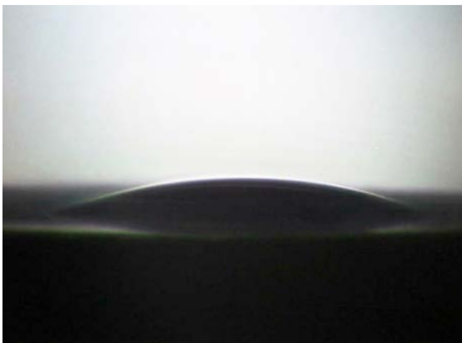
Figura 23 - Medida do ângulo de contato da Placa de aço-carbono após 15 dias de imersão em etanol da Shell, sem adição de inibidor.
