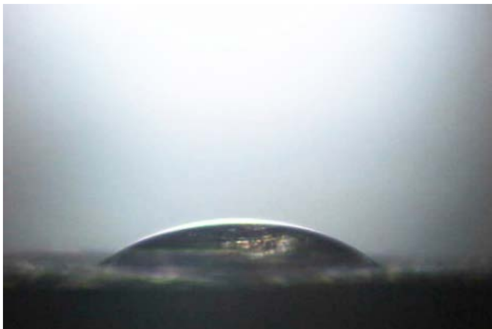
Figura 3 - Medida do ângulo de contato da Placa de aço-carbono após 15 dias de imersão em etanol da da Petrobrás, após 15 dias de imersão.
