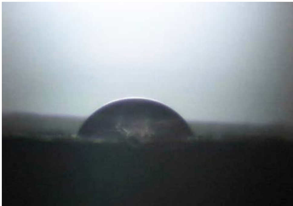
Figura 28 - Medida do ângulo de contato da Placa de aço-carbono após 15 dias de imersão em etanol da Petrobrás após 15 dias de imersão com adição de 100 mM de inibidor.
