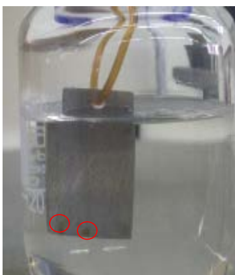
Figura 13 - Placa de aço-carbono imersa em etanol da Petrobrás após 15 dias de imersão, com adição de 50 mM de inibidor.
