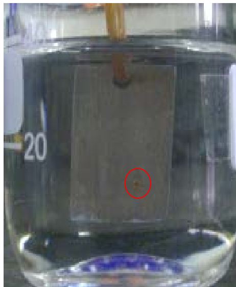
Figura 9 - Placa de aço-carbono imersa em etanol da Ipiranga após 15 dias de imersão, com adição de 100 mM de inibidor.
