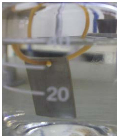
Figura 16 - Placa de aço-carbono imersa em etanol da Petrobrás após 15 dias de imersão, com adição de 5 % de água + 100 mM de inibidor
