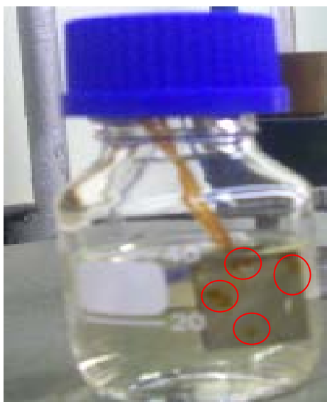
Figura 5 - Placa de aço-carbono imersa em etanol da Shell após 15 dias de imersão, com adição de 5 % de água.
