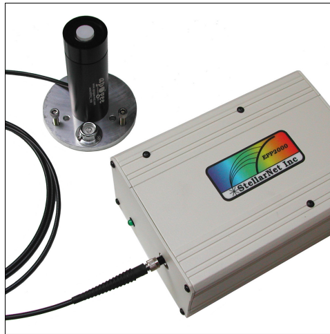
Figura 5.7: Fotografia do espectrorradiômetro portátil modelo SPEC-PAR/NIR produzido pela empresa APOGEE. Este espectrorradiômetro realiza medidas radiométricas entre 350 e 1000 nm com resolução de 0,5 nm. Fonte: APOGEE [2007].
