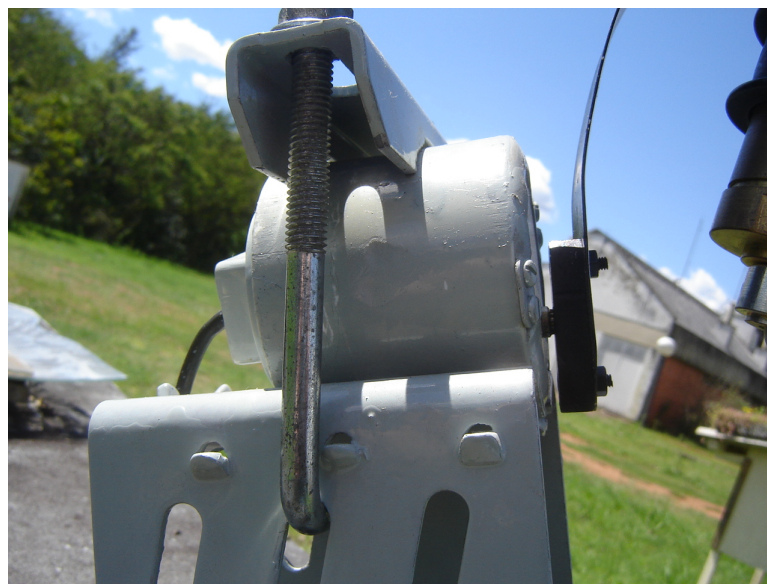
Figura 5.12: Foto onde é mostrado o motor que comanda o anel de sombra rotativo do radiômetro espectral.
