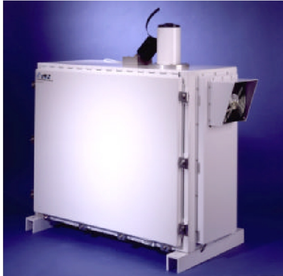
Figura 5.6: Fotografia do espectrorradiômetro modelo RSS produzido pela empresa YES. Este espectrorradiômetro possui um anel de sombra rotativo para medida espectral das componentes global, direta e difusa da irradiância solar. Fonte: YES [2007].
