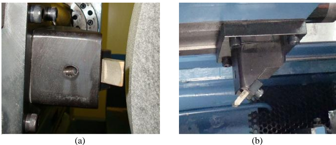
Figura 4.2. Dressador tipo fliesen usado nos ensaios: (a) vista lateral; (b) vista superior
