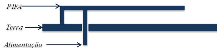
**Figura 22 Antena Planar de formato F-invertido.**
