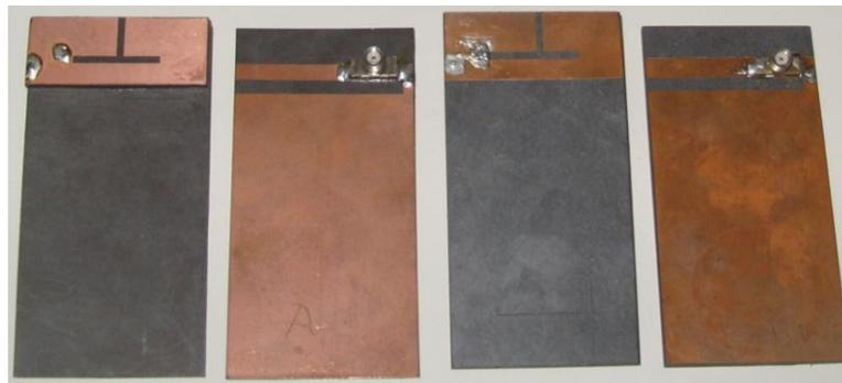
**Figura 79** Protótipos de antenas realizados para medição de perda de retorno e diagramas de irradiação.
