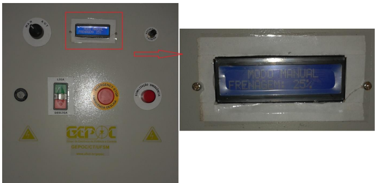
Figura 4.14 - Painel de controle do sistema de frenagem; detalhe para o mostrador do percentual de capacidade de frenagem utilizada
