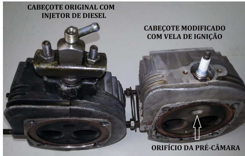
Figura 4.5 - Cabeçote original com injetor de diesel e cabeçote modificado com vela de ignição
