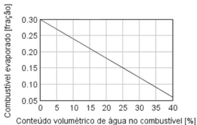
Figura 5.4 - Fração volumétrica vaporizada em função da fração volumétrica de etanol na mistura
