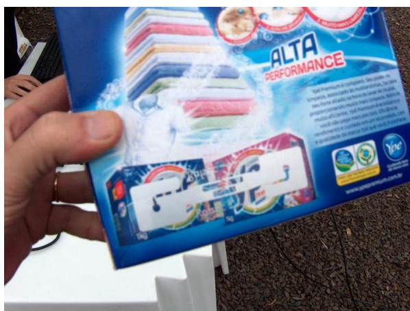
Figura 36 – Tag passiva UHF, colada num produto
