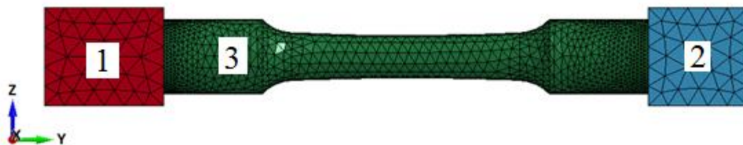
Figura 5.2 – Malha de elementos finitos do corpo de prova.
