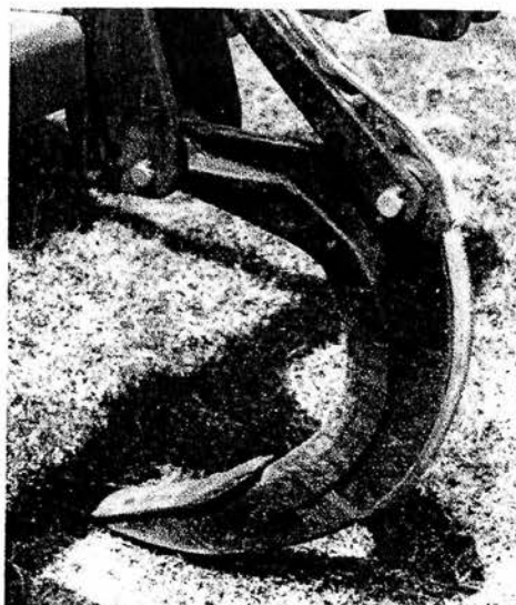
FIGURA 20 – Sensor de esforço de tração, acoplado à haste do escarificador.
