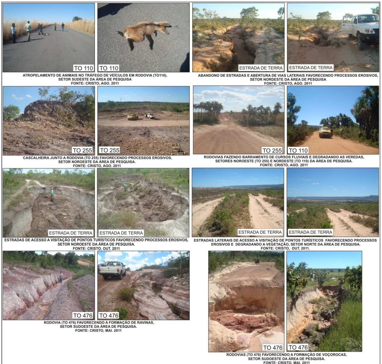
Figura 72 – Visualização das interferências ocasionadas pelas vias de circulação (rodovias) na Fauna, na Flora e nas Feições Geomorfológicas da área de pesquisa.
