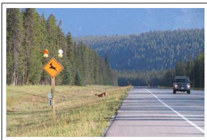
Figura 74. Sinal piscante ativado por câmaras de infravermelho no Canadá. A detecção envolve combinação de movimento, tamanho e velocidade do animal para acionar o sistema. (HUIJSER et al. 2006).
