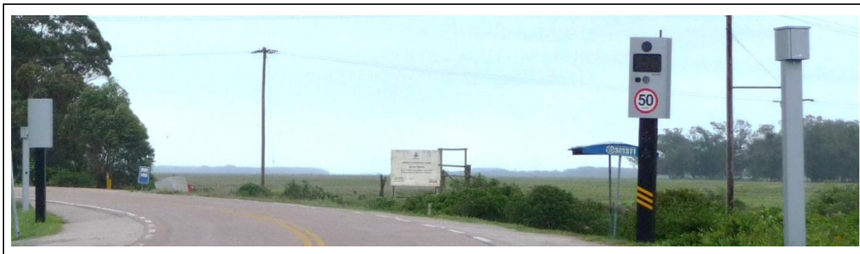
Figura 73. Controlador eletrônico de velocidade. BR 471, Estação Ecológica do Taim, Santa Vitória do Palmar/RS.
