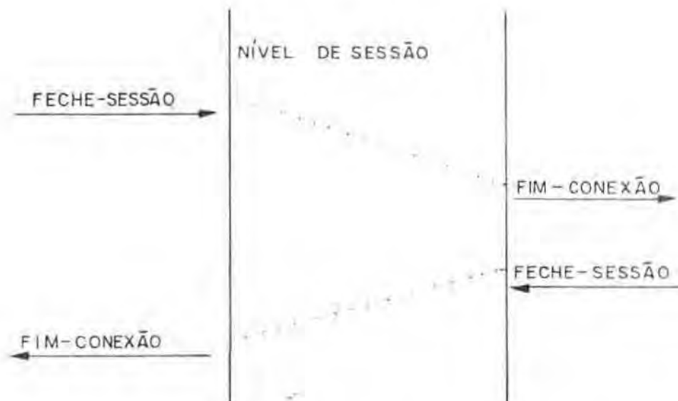
Fig. 8 - Primitivas de Serviço para Desconexão Normal
