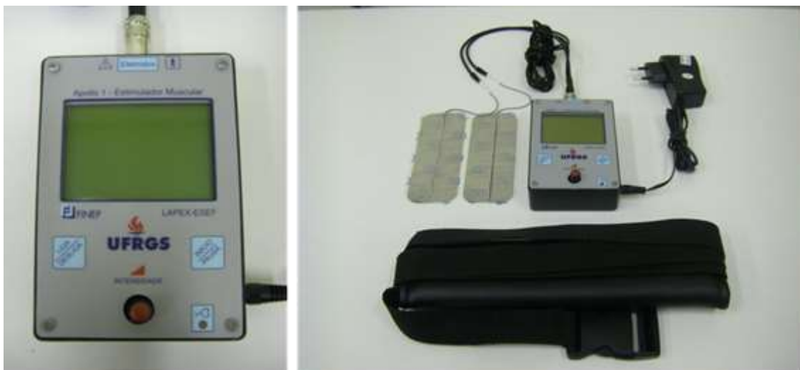
Figura 1. Estimulador elétrico amigável ao idoso construído especialmente para uso domiciliar no tratamento da inibição muscular e fortalecimento dos extensores do joelho. Funciona por meio de três botões (liga/desliga; início/pausa; e intensidade) pelos quais o idoso aciona a seção de tratamento com apenas três comandos. Ao final da seção, o aparelho grava o registro antes de desligar automaticamente. O sistema ainda acompanha um par de eletrodos autoadesivos, um carregador de dupla voltagem e uma faixa especial para fixação do tornozelo.
