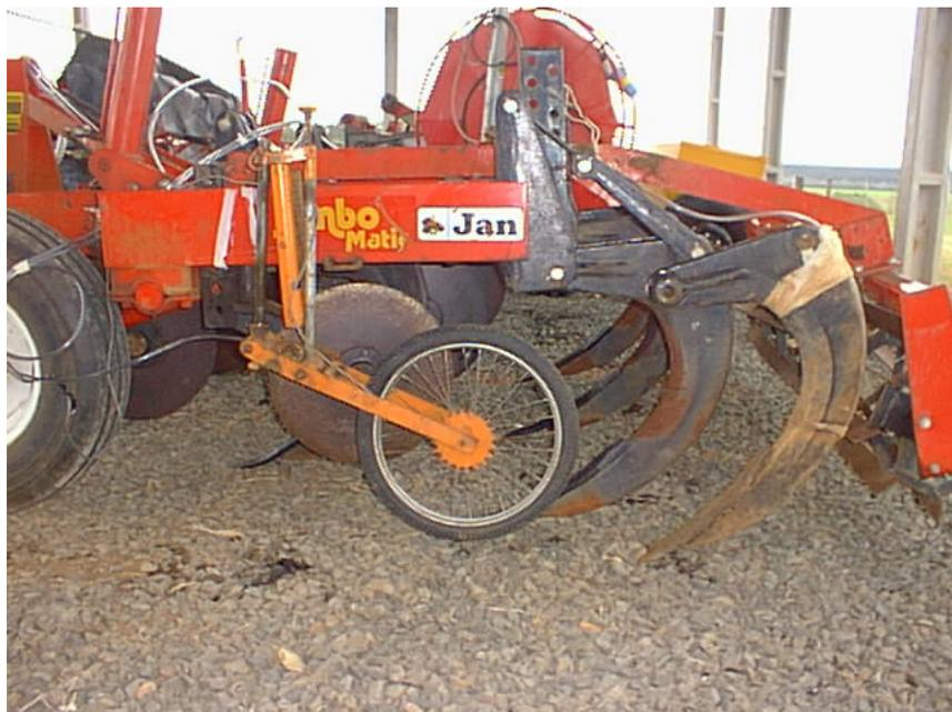
**Figura 24: Profundímetro e roda odométrica**
