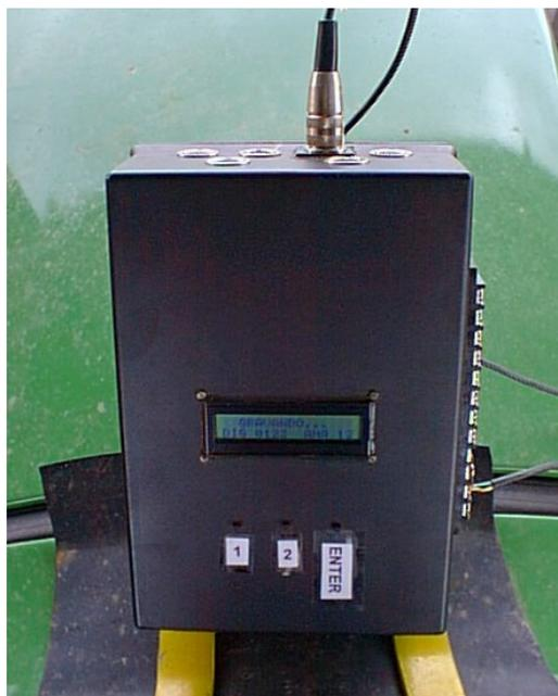
**Figura 7: Sistema de aquisição de dados desenvolvido no IEE-UFRGS**
