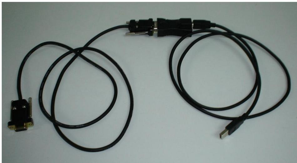
**Figura 13: Conversor serial para USB**
