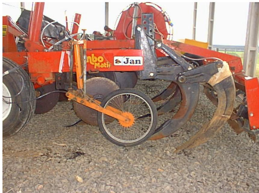
**Figura 9: Roda odométrica e escarificador instrumentado**
