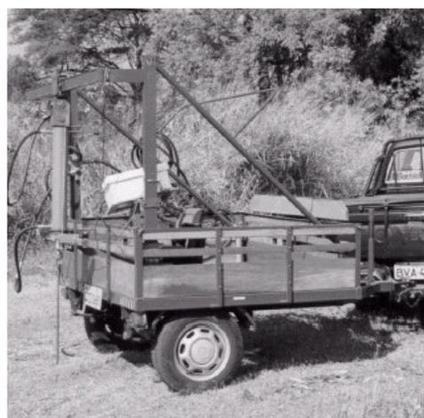
**Figura 6: Penetrômetro desenvolvido por Santos**
