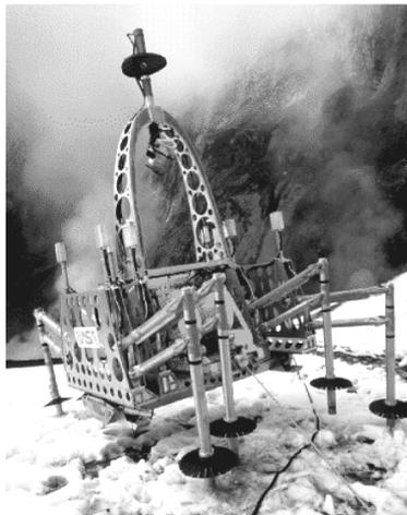
Figura 5: Robô dotado de pernas, capaz de se locomover em ambientes não estruturados, como por exemplo um vulcão.
