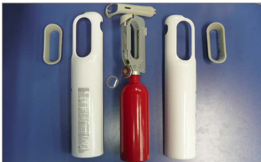
Figura 9: Similar HomeHero parcialmente desmontado
