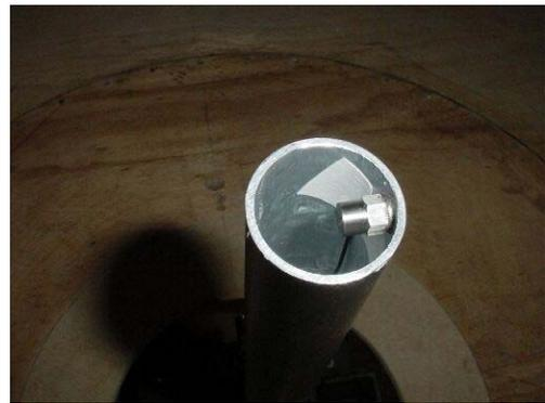
**FIGURA 4.12** – Fixação do acelerômetro no modelo
