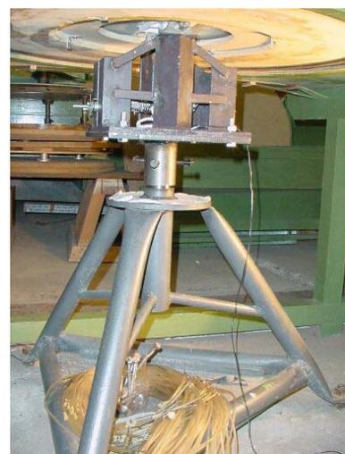
FIGURA 4.9 – Sistema mecânico fixo sobre a base rígida (tripé)
