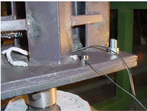
**FIGURA 4.11** – Fixação do acelerômetro na base
