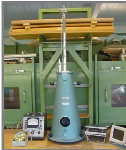
**FIGURA 4.3** – Micromanômetro à água tipo BETZ
