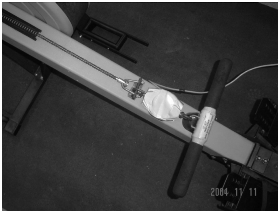
Figura 5- Célula de carga Laboratório de Medições Mecânicas UFGRS instalada no remoergômetro
