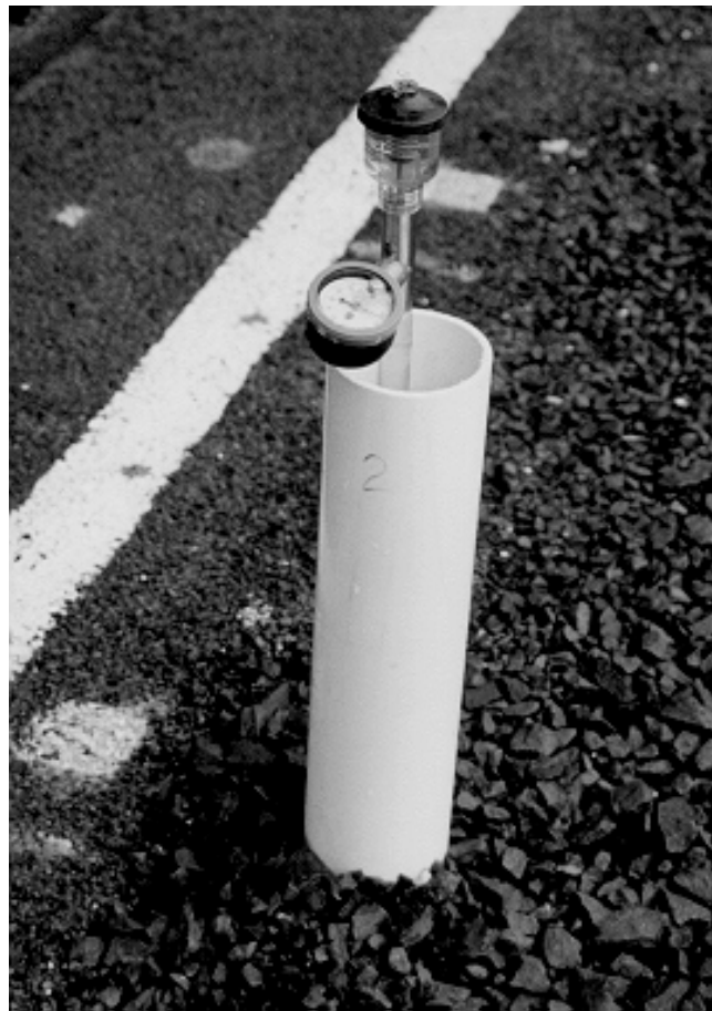
FIGURA 3.11 - Tensiômetro (JET FILL da Soilmoisture Equipment Corporation) instalado com proteção de PVC acima da superfície do pavimento.
