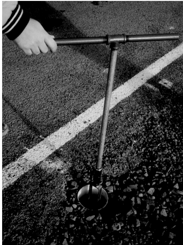
FIGURA 3.9 - Método de instalação dos tensiômetros na área de testes.
