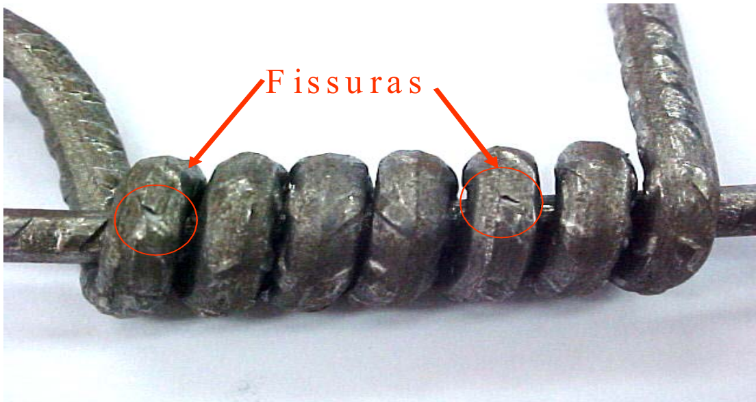
Figura 4.13: Resultado do ensaio de enrolamento da amostra N2.
