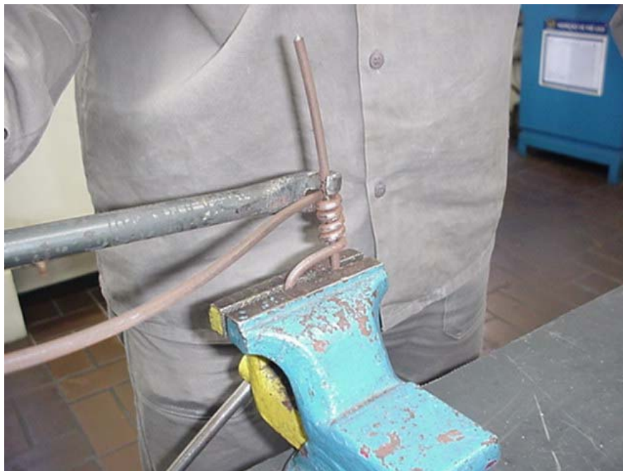
Figura 3.1. Demonstração do ensaio de enrolamento de um material, ao redor do seu próprio eixo, com o auxílio de uma “chave” apropriada e de uma morsa.
