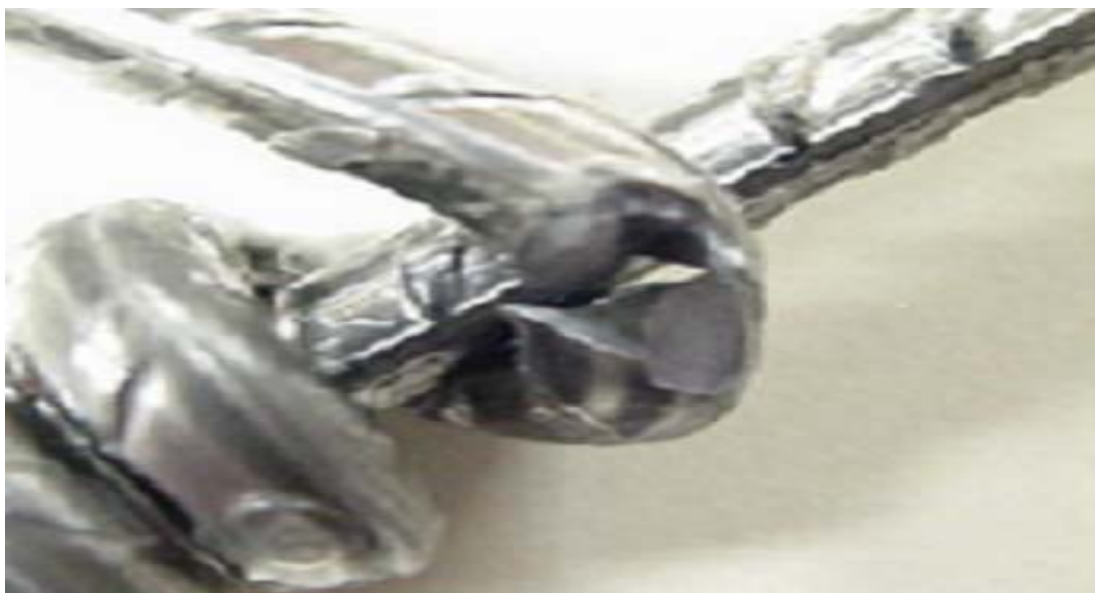
Figura 4.14: Resultado do ensaio de enrolamento da amostra N3, que demonstra o rompimento do material após dobramento.
