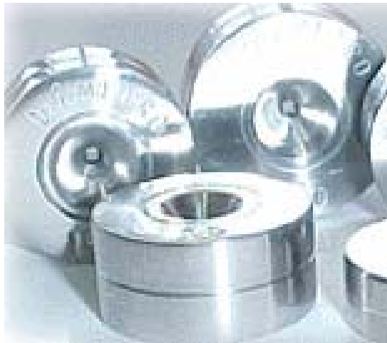
Figura 2.1: Fieiras usadas na fabricação de arames de aço carbono ( http://www.diametro-fieiras.com.br/portugues/menu/diamantepolicristalino.htm ).
