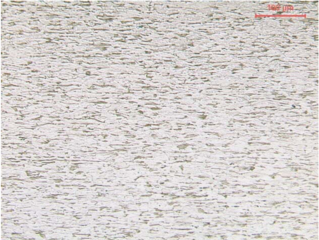
Figura 4.3. Microestrutura da região longitudinal do arame com bitola de 3,62mm ou P3 (Passe 3), com taxa de encruamento de 70%. (200x).
