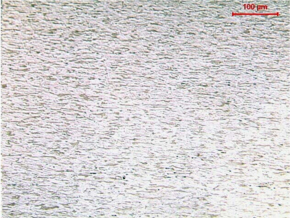
Figura 4.4. Microestrutura da região longitudinal do P4 (Passe 4). Arame com dimensional de 3,24mm, com taxa de encruamento de 80%. (200x).
