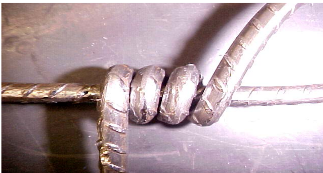
Figura 4.12 Foto do resultado do ensaio de enrolamento da amostra N1.
