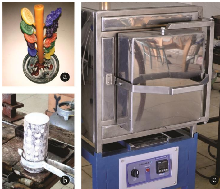
(a) Construção da árvore de modelos com as peças em diferentes tipos de cera; (b) construção do molde em refratário cerâmico; e (c) equipamento utilizado para deceragem e calcinação.
