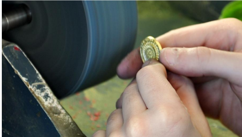
Figura 38 – Processo de acabamento das peças após retirá-las da árvore de modelos.
