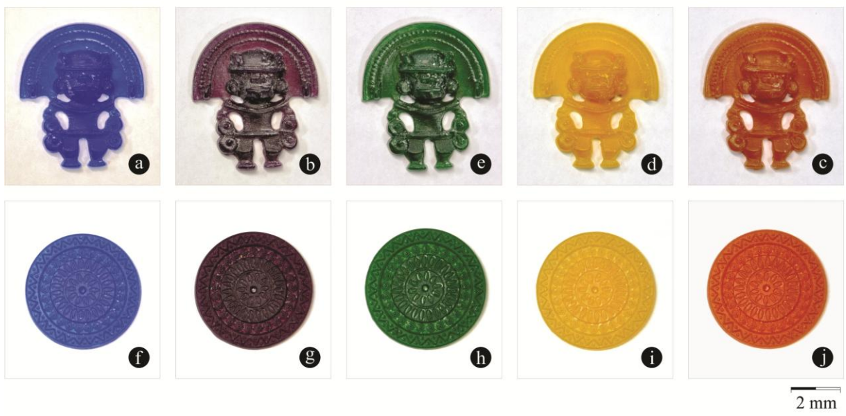
Figura 53 – Modelos produzidos pela usinagem CNC de cera para modelagem.
