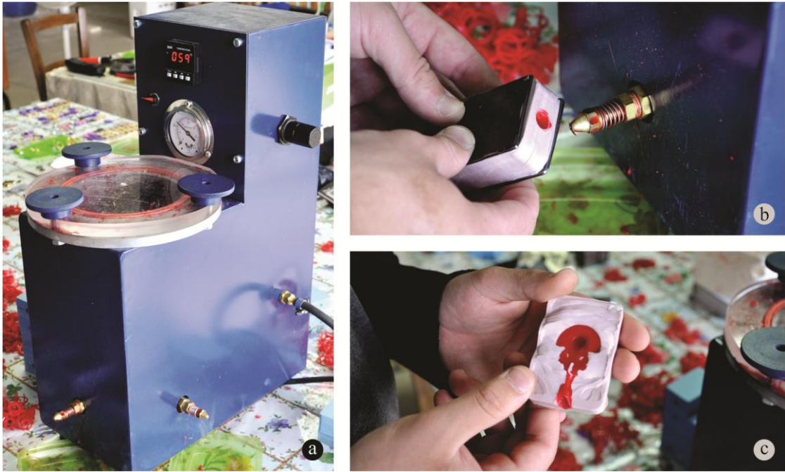
(a) Equipamento de injeção; (b) Preenchimento do molde com cera para injeção; e (c) Cera sólida com o formato do modelo.
