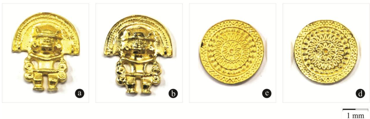
Figura 56 – Peças piloto em estado bruto e após receber polimento.
