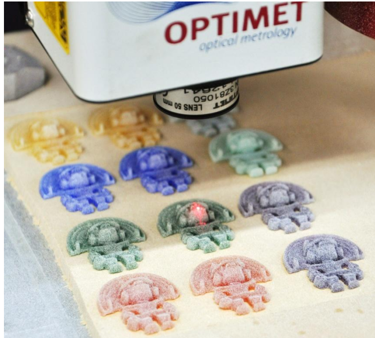
Figura 42 – Digitalização dos modelos, recobertos pelo pó revelador, com o escâner Digimill 3D, LdSM/UFRGS.
