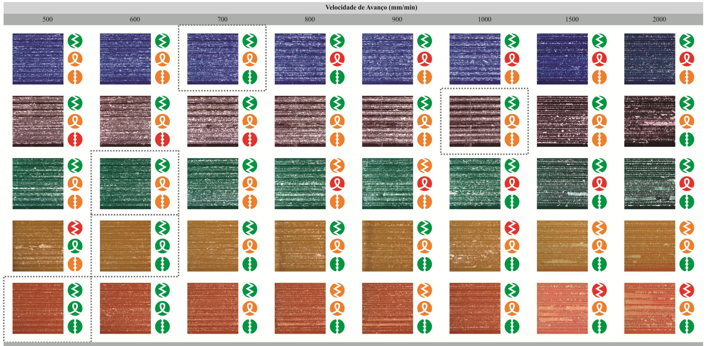
Quadro 4 – Resultado dos cortes gerados nas ceras para modelagem em diferentes velocidades de avanço. Em destaque os melhores resultados.
