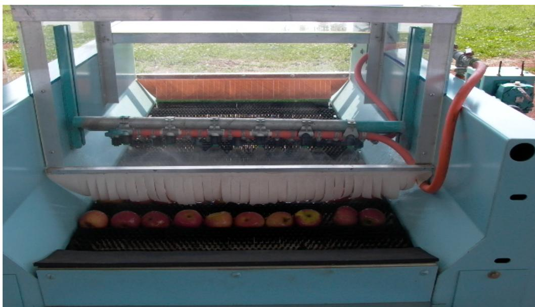
FIGURA 4. Detalhe da barra com os bicos de aspersão de água do tipo leque (Marca Jacto, mod. 110-SF-015), Vacaria, RS, 2000.
