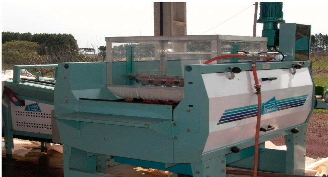
FIGURA 3. Detalhe do equipamento para a aspersão da água, acoplado a máquina classificadora de frutos, Vacaria, RS, 2000.
