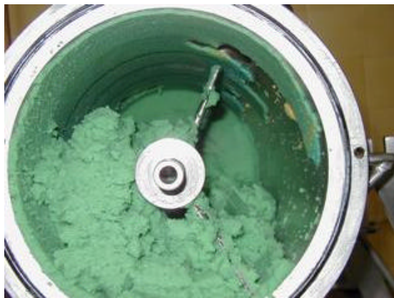
Figura 6: Aspecto do biorreator após 15 minutos de teste de mistura radial.
