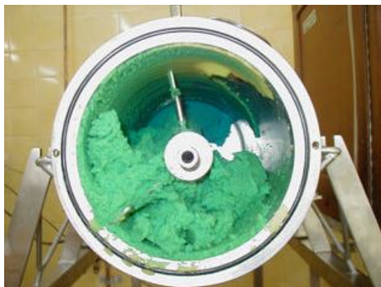
Figura 7: Aspecto do biorreator após 45 minutos de teste de mistura axial.
