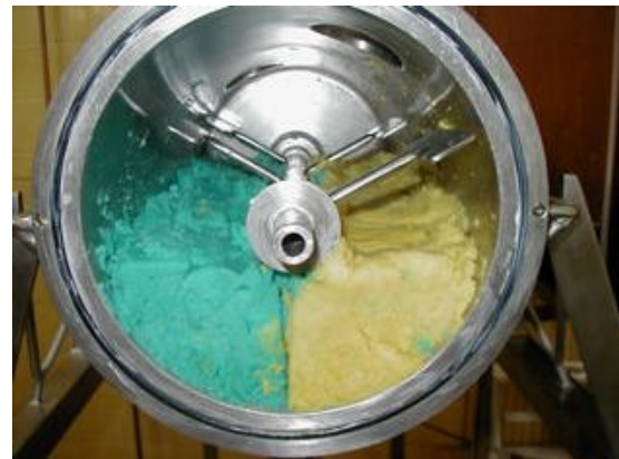
Figura 3: Disposição inicial da fibra no teste de mistura radial
