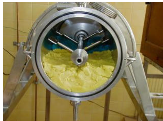
Figura 4: Disposição inicial da fibra no teste de mistura axial
