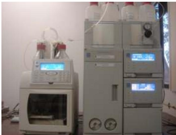
Figura 4 – Equipamento Metrohm, utilizado para análise de ânions e cátions simultânea no laboratório da Equipe de Análises Instrumentais em Cromatografia do DMAE.
