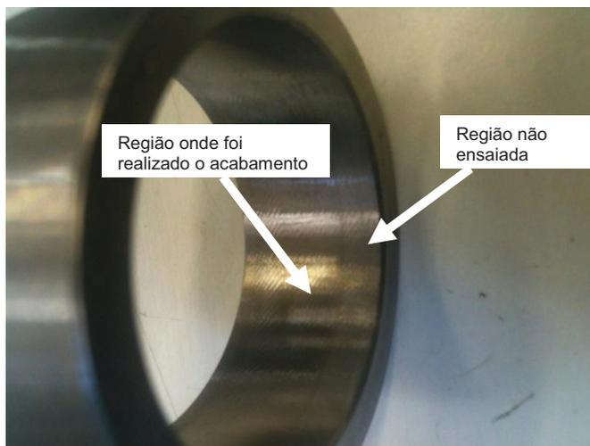
Figura 6.1 Detalhe da peça após usinagem
