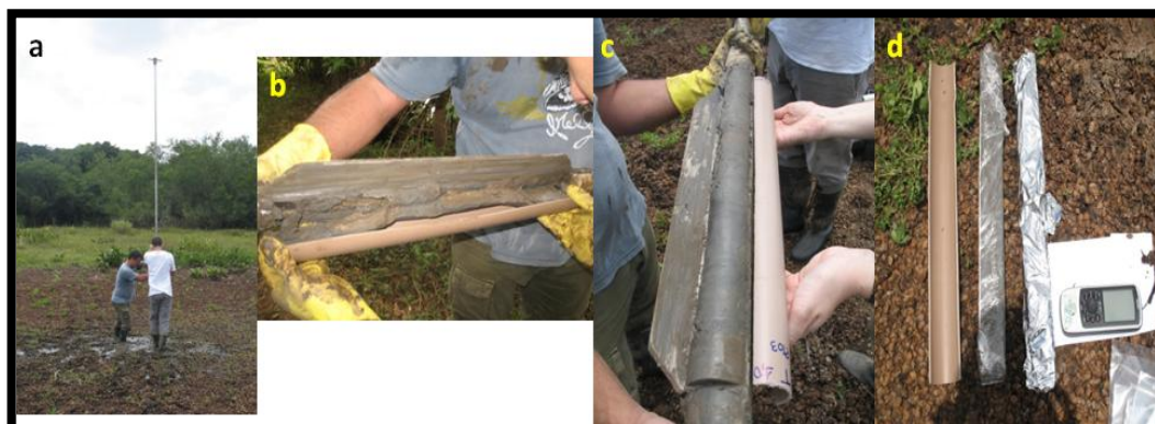
Figura 13. Amostragem dos testemunhos com o amostrador Russian Peat Borer (a), retirada do material para a calha de PVC (b,c) e preservação do testemunho (d).
