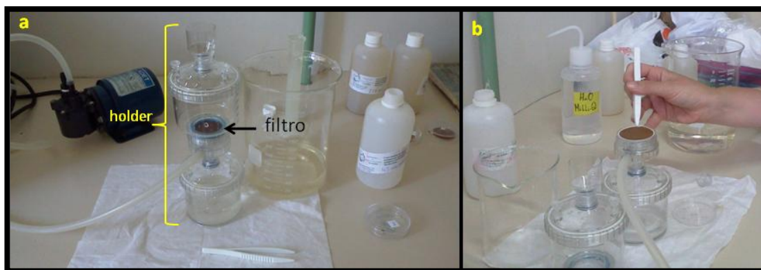
Figura 15. a) Filtragem do material particulado da água coletada no rio e nos banhados. b) Filtro sendo retirado depois da filtragem.
