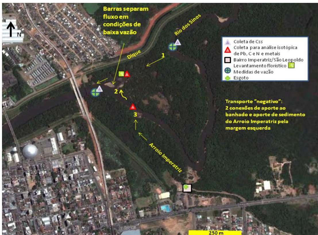
Figura 24. Diferentes conexões de água (setas amarelas 1, 2 e 3) que contribuem para o aporte de sedimento; pontos de coleta para análise química do banhado B3. Fonte: Imagem Google Earth 2012.
