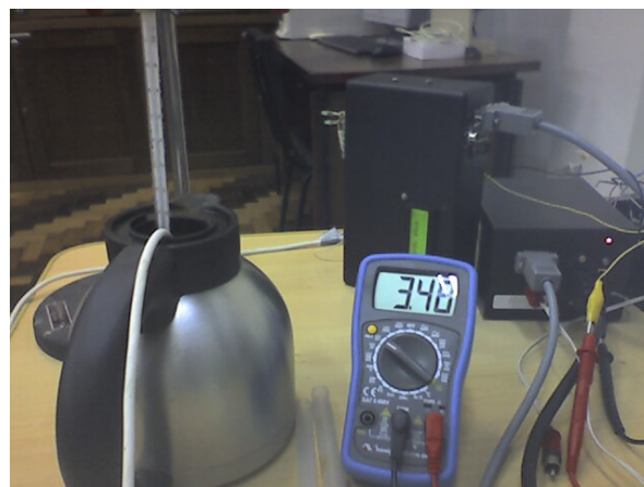
Figura 4.11: Execução do teste do sensor de temperatura com termômetro de mercúrio
