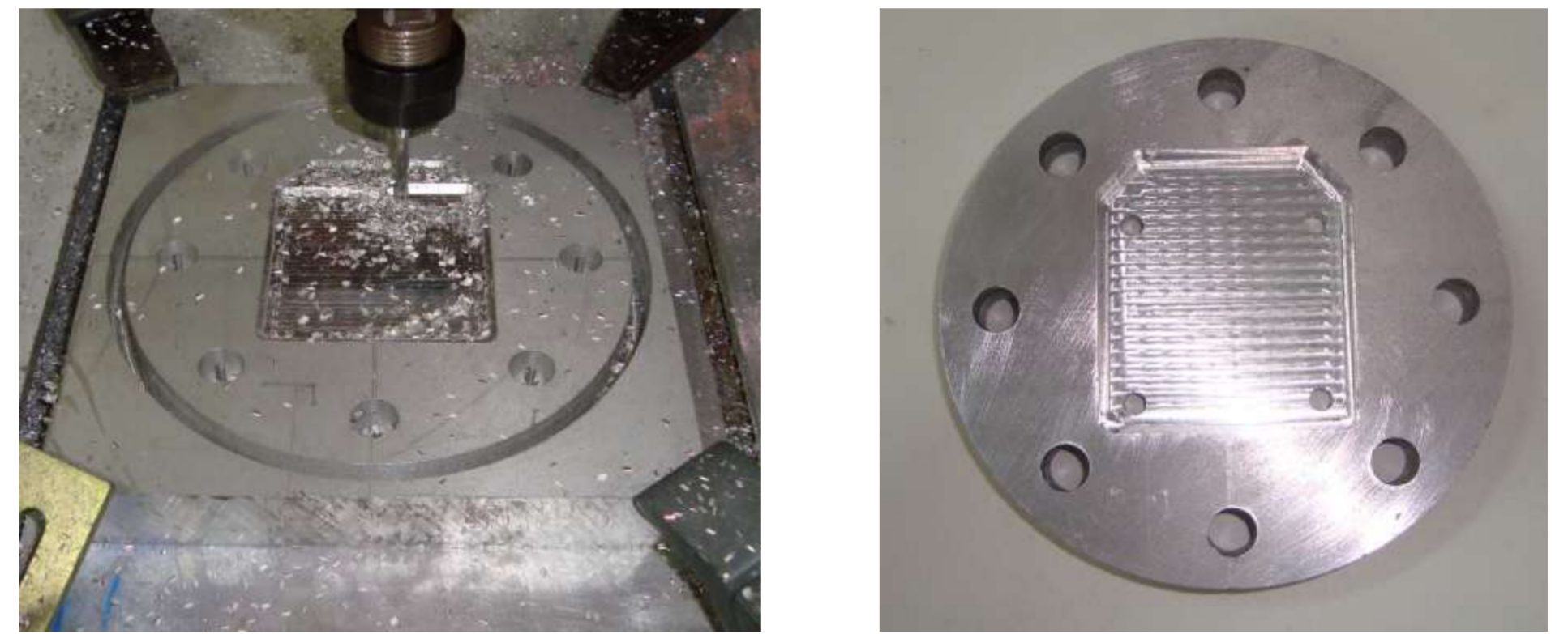
Figura 2 – Peça usinada para fabricação do acoplamento entre 1º e 2º grau de liberdade.
