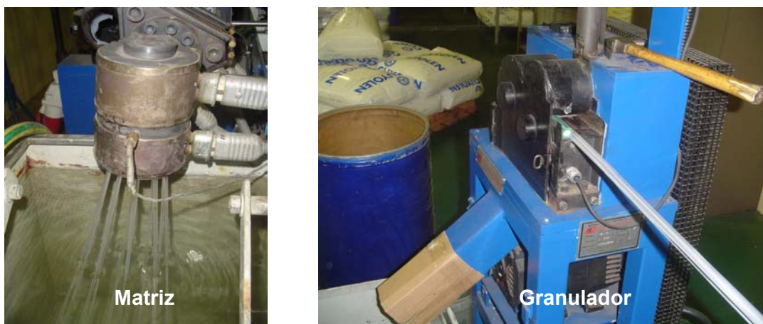
Figura 3.2-5: Fotos da matriz e do granulador utilizados nos experimentos com o PP.
