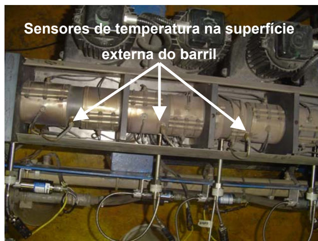
Figura 3.2-3: Foto da extrusora destacando as zonas de aquecimento do barril.
