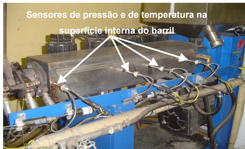
Figura 3.2-2: Foto da extrusora destacando os sensores de pressão e de temperatura.
