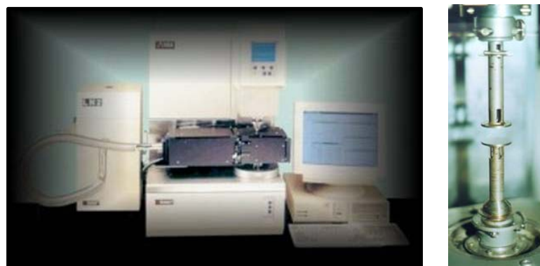
Figura 3.2-6: Fotos do reômetro rotacional e da geometria de ensaios utilizados.
