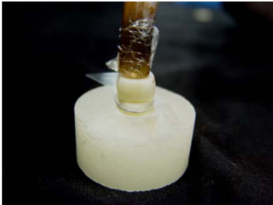
Fig 9. Ponteira do aparelho protegida com filme de PVC, sendo colocada sobre o espaçador de 6 mm.
