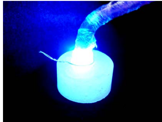
Fig 10. Fotoativação do corpo de prova.
