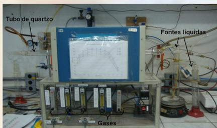
Figura 1: Reator DQVC de leito horizontal
