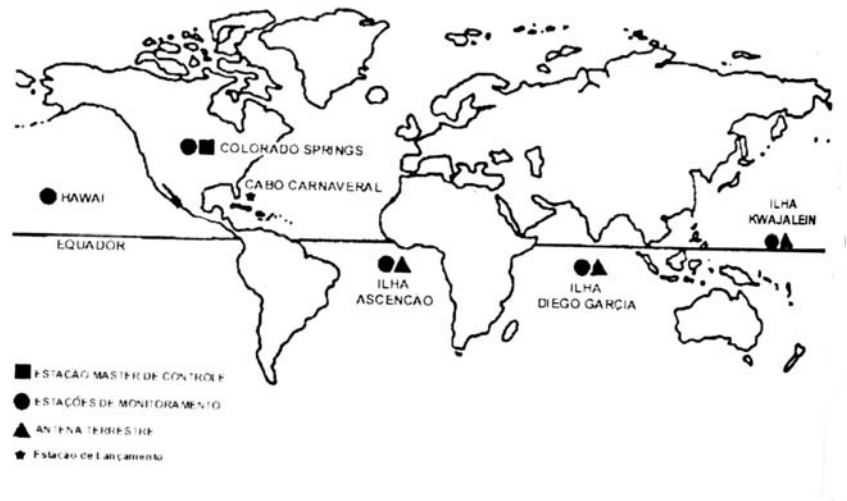
Figura 15 - Estação de monitoramento GPS. (Fonte: Adaptado de Silva et al., 1997).
