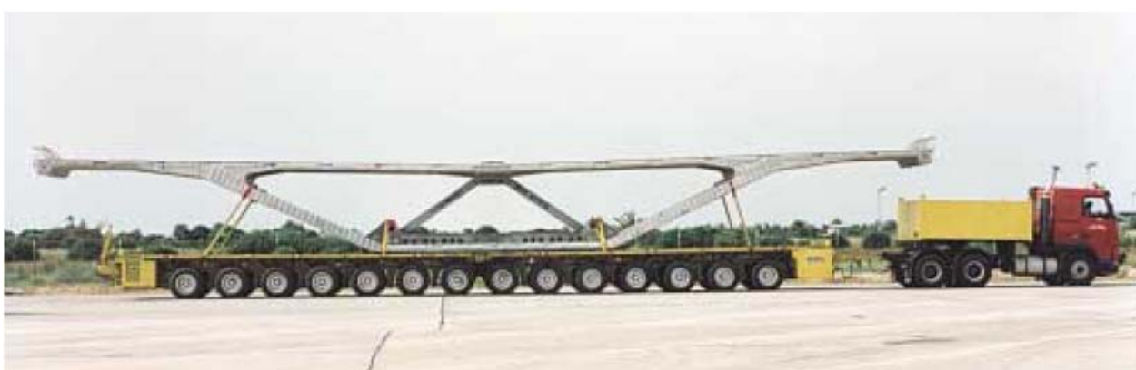
Figura 1.9 – Transporte de aduelas (Brockmann e Rogenhofer, 2000)
