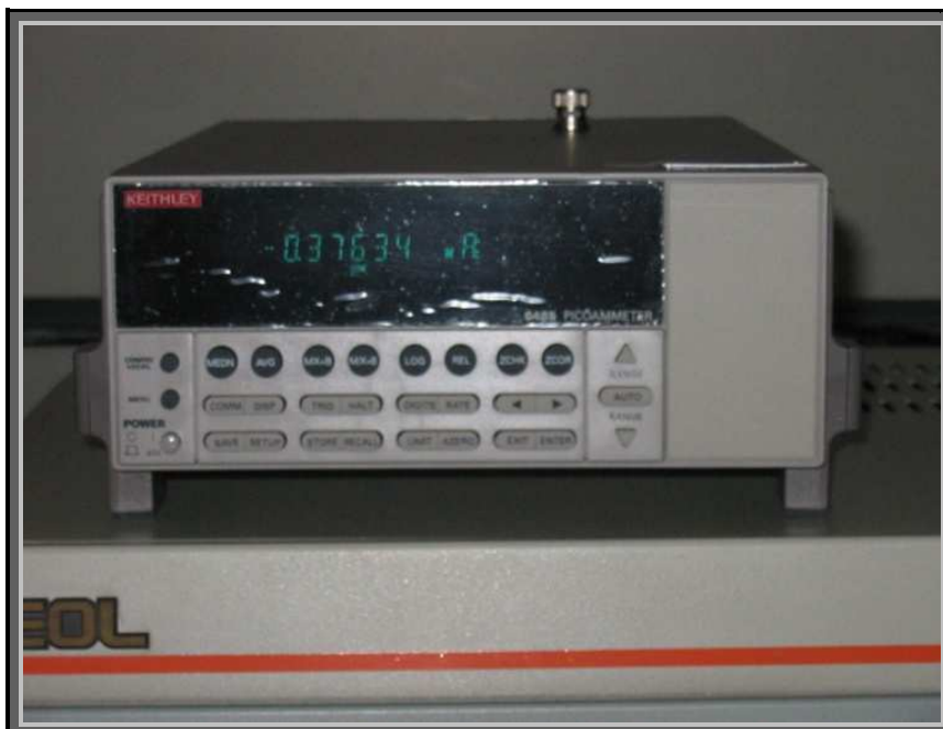
Figura 26 - Parte frontal do picoamperímetro Keithley®. Este equipamento, acoplado ao microscópio eletrônico de varredura é capaz de medir variações na corrente na ordem de 10^{-13} A ou 10pA.
