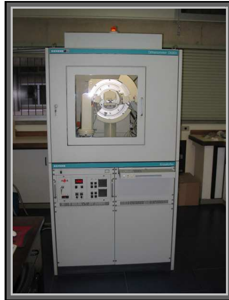
Figura 29 - Difratorômetro de Raios-X modelo Siemens D5000, goniômetro \Theta - \Theta , utilizado nos estudos mineralógicos dos argilominerais do projeto.
