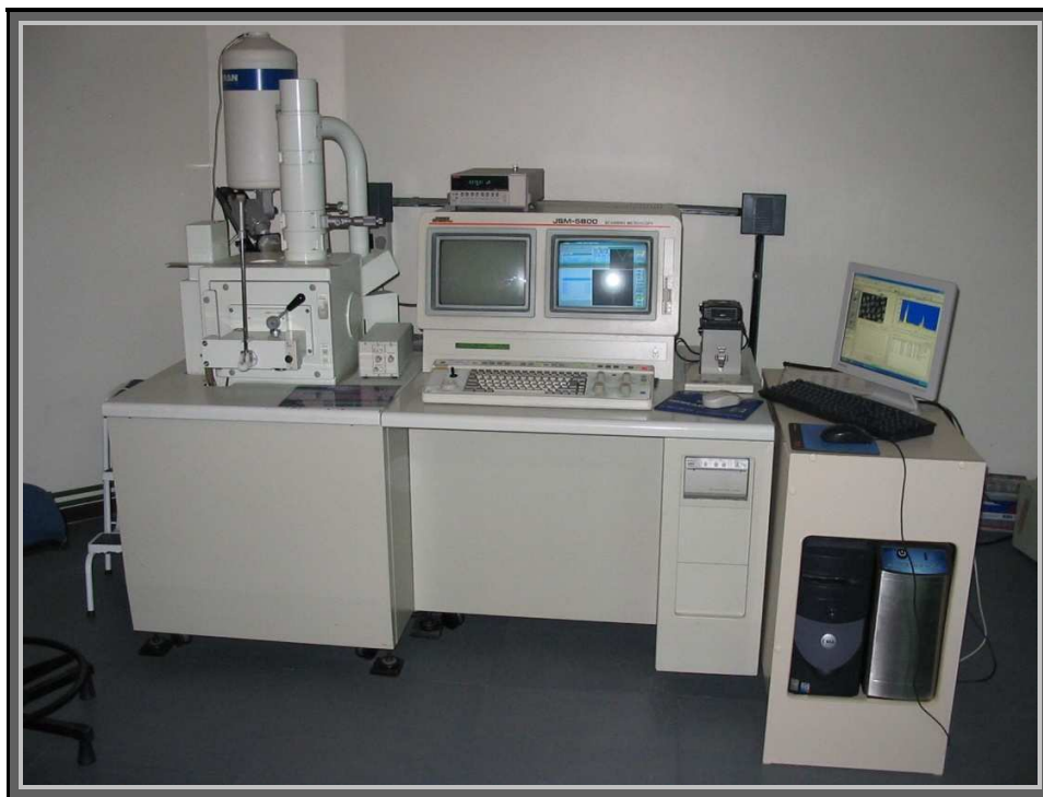
Figura 24 - Visão geral do Microscópio Eletrônico de Varredura – JEOL JSM-5800, equipado com um espectrômetro EDS utilizado no projeto.
