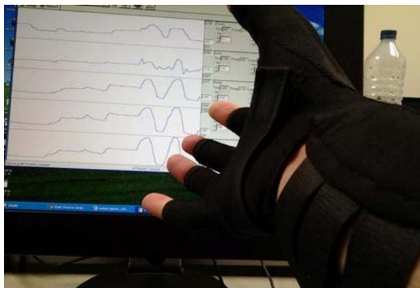
O artefato demonstrou-se eficiente à captura do movimento dos dedos durante o ensaio. A flexão e extensão dos dedos alteram as propriedades físicas dos sensores e estas alterações são visualizadas em forma de gráficos no *software* de operação da luva. Cada linha no gráfico representa um dedo e os dados apresentados são relacionados à amplitude variada em função do movimento em intervalos de tempo.
