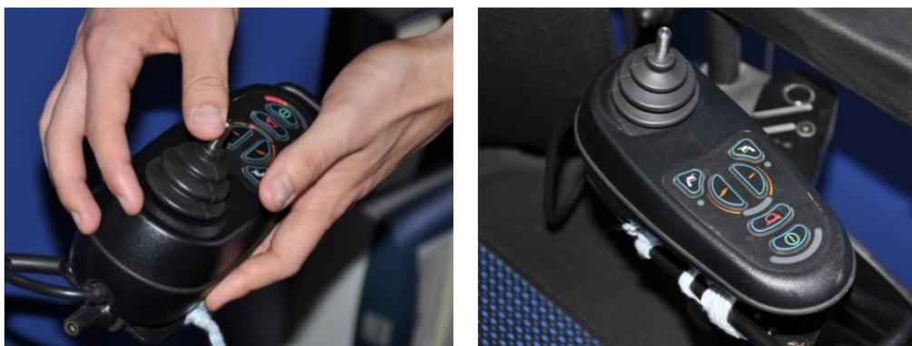
O *joystick* é composto basicamente de três partes: a placa do circuito eletrônico (Figura 46); a carenagem em polímero (Figura 47a) e a alavanca modelo JC2000 (Figura 47b), fabricada pela empresa americana Penny & Giles Controls. O fabricante descreve o componente como *joystick* multi eixos sem contato. Em revendedor autorizado na Argentina, encontra-se a venda por 250,00 dólares, aproximadamente 500,00 reais.
