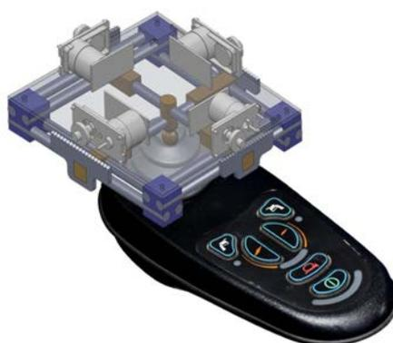
Com base no design do sistema mecânico, na avaliação do seu funcionamento nos protótipos 3D, na experiência adquirida em processos de fabricação na prototipagem, no teste de funcionamento das buchas deslizantes sobre os eixos, no redesign do sistema e na avaliação do seu funcionamento nos protótipos virtuais prevê-se que um protótipo do sistema mecânico duplo eixo tenha funcionamento pleno e robusto.
