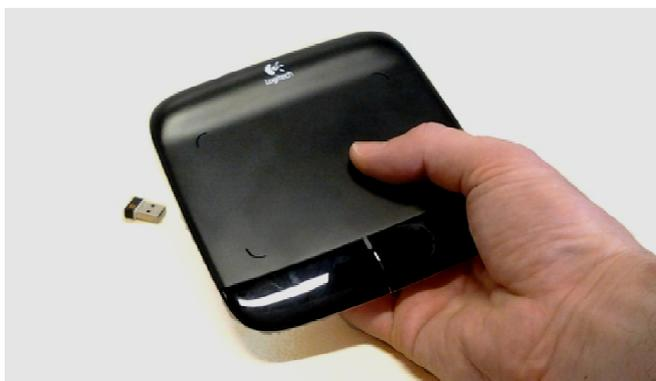
O *touchpad* possui um grande potencial para o controle de cadeiras de rodas, visto que bastaria o usuário deslizar seu dedo sobre a superfície do painel na direção em que deseja se deslocar. O sinal gerado seria direcionado a um circuito eletrônico de controle, o qual faria o acionamento de atuadores eletromecânicos.
