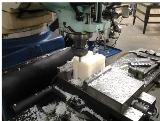
**Figura 80: Furação e torneamento do sistema mecânico**
