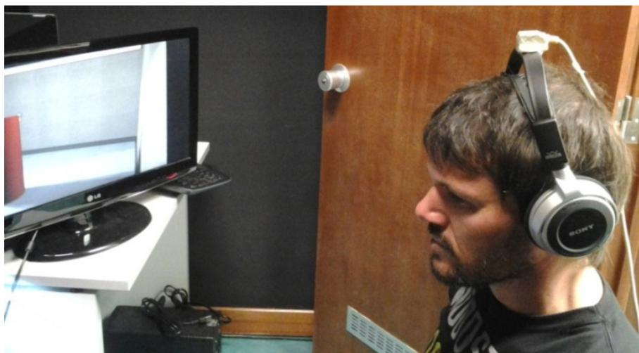
Os movimentos da cabeça foram capturados em tempo real e o resultado aplicado ao posicionamento dentro de um ambiente virtual monitorado. Um fator limitante do sistema é a suscetibilidade a interferências eletromagnéticas produzidas por outros equipamentos elétricos ou eletrônicos, como celulares e computadores, bem como de peças metálicas que afetam a precisão da captura.
