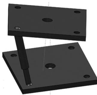
O conceito de discos giratórios (Figura 72a) foi estudado e avaliado com maior critério. A ideia propõe o giro de um disco para habilitar a direção e outro para mover a alavanca. As Figuras 72b e 72c são variações do mesmo sistema apresentando alternativas para instalação dos servomotores junto às engrenagens.
