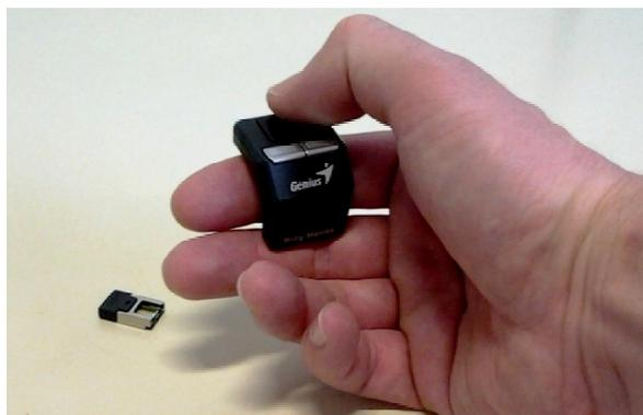
Os ensaios com o Ring Mouse no ErgoVR demonstraram que com apenas um dedo é possível controlar o cursor de um computador. O artefato possui botões com as funções de clique esquerdo e direito de um mouse convencional, além de repetir a função do clique esquerdo sob a área do *touchpad*. A navegação é suave, porém são necessárias várias rolagens para se atingir toda a área de navegação na tela do computador.
