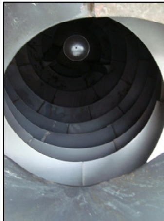
Figura 27: condições internas do balão do caminhão utilizado
