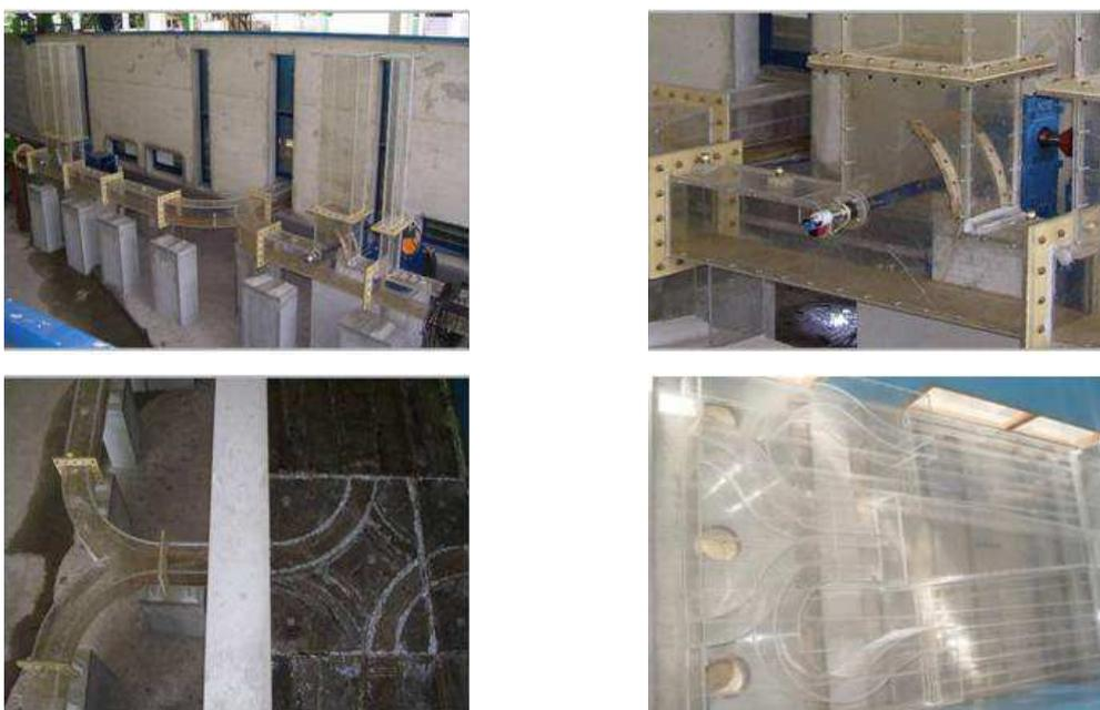
Figura 20. Detalhes das estruturas construídas em acrílico no modelo reduzido
