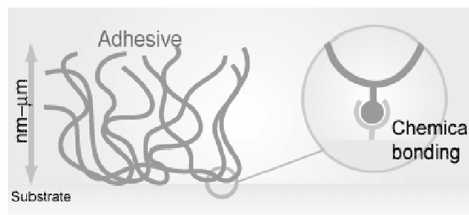
Figura 20. Adesão por ligações químicas primárias entre adesivo e substrato [54].
