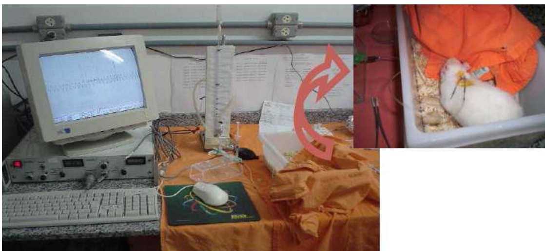
Figura 6: Sistema de registro de pressão arterial e conexão entre a cânula e o transdutor eletromagnético.
