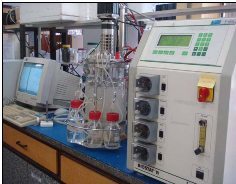
Figura 2.1: Biorreator de 5L com unidade de controle acoplada.
