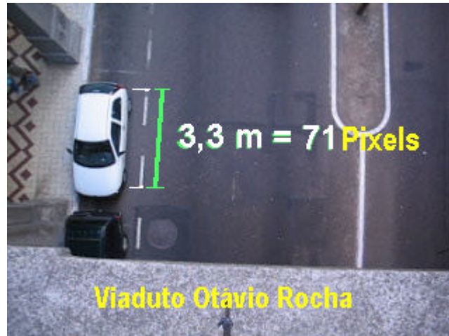
Figura 44 –Relação pixel x metros para amostras #1 a #18
