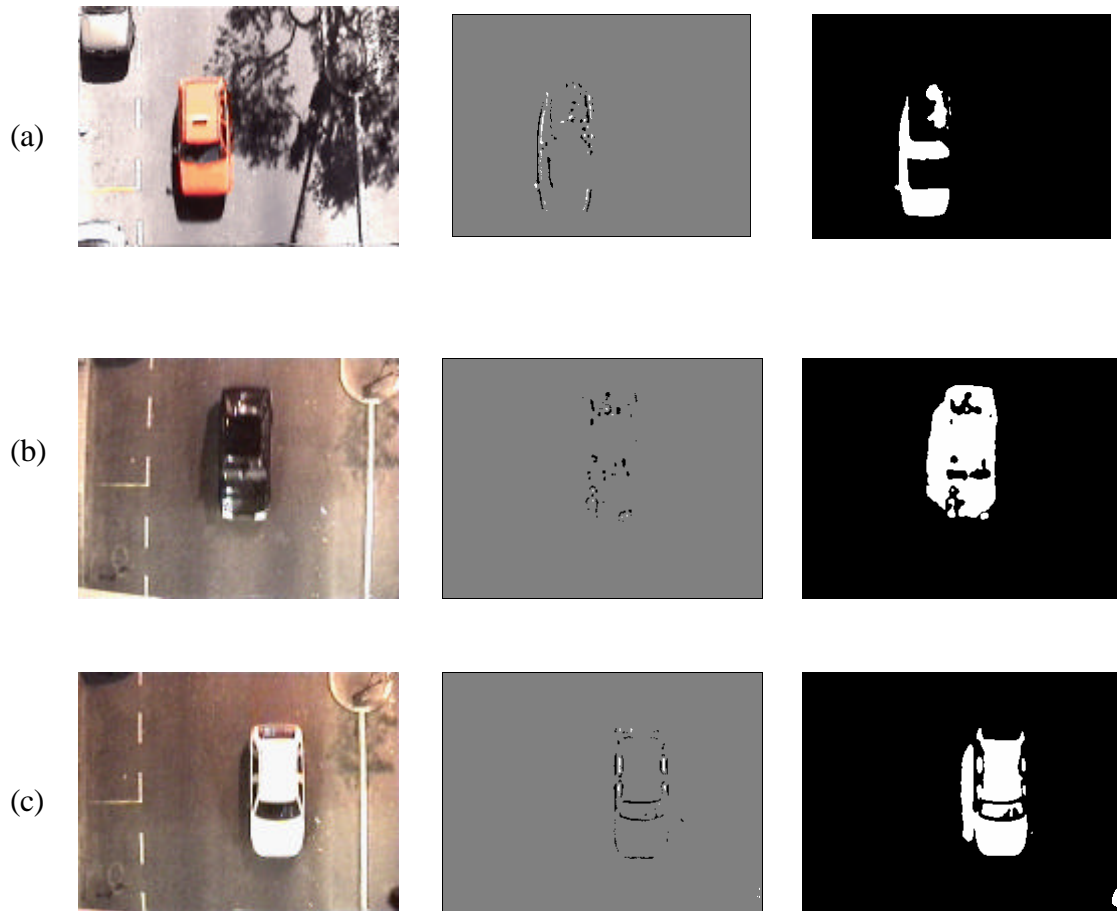
Figura 31 – Resultados da determinação do limiar pelo método Laplaciano. a) Amostra A, sol das 14h, th = 75 . b) Amostra B, 21h, com iluminação artificial, th = 63 . c) Amostra C, 19h, sem iluminação artificial, th = 68 .
