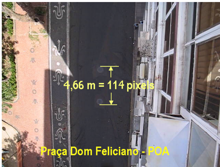
Figura 49 –Relação pixel x metros para amostras #19 a #23
