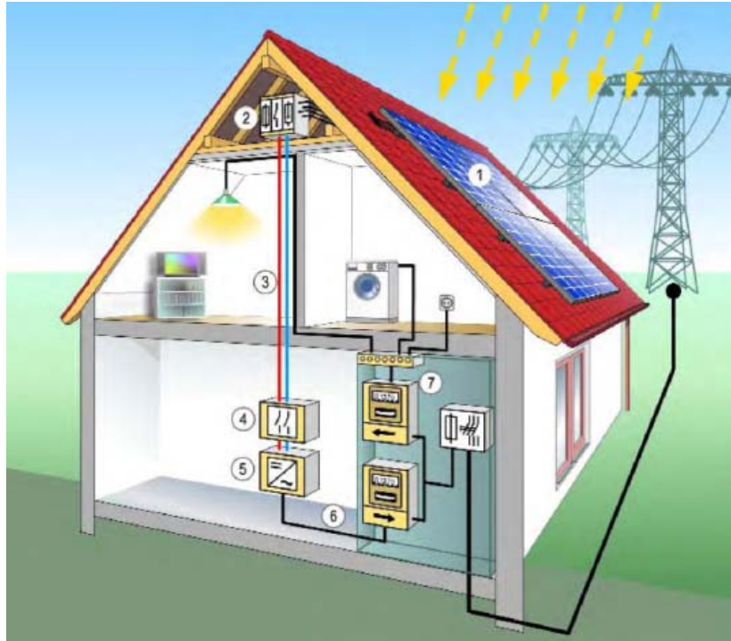
Figura 1.2 – Sistema fotovoltaico conectado à rede instalado em uma residência: (1) gerador fotovoltaico, (2) caixa de conexões CC, (3) cabeamento, (4) disjuntores de proteção, (5) inversor, (6) cabeamento CA e (7) quadros de medição, distribuição e disjuntor CA [DGS, 2008].
