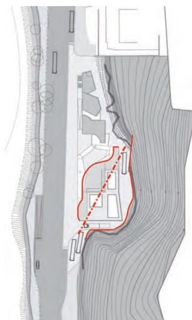
3.179. Esquema comparativo das curvas de nível do terreno e forma do edifício
