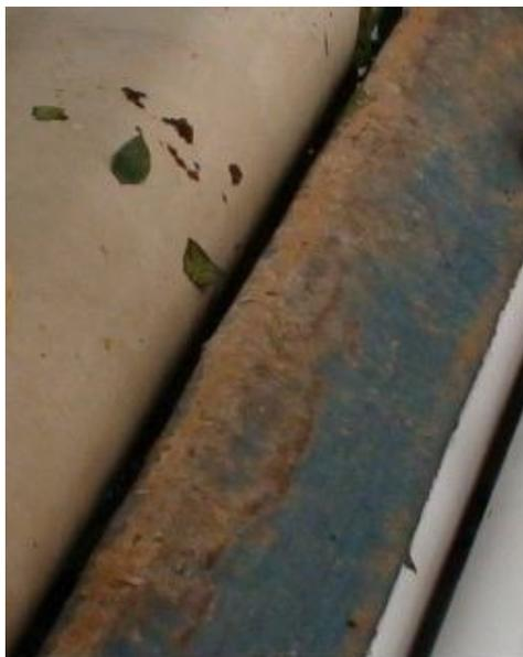
FIGURA 15. Rampa emborrachada com sinais de desgaste no ponto de transferência entre a esteira rolante e o elevador de roletes, em linha de beneficiamento de peras de uma casa de embalagem comercial. Bento Gonçalves, 2011.
