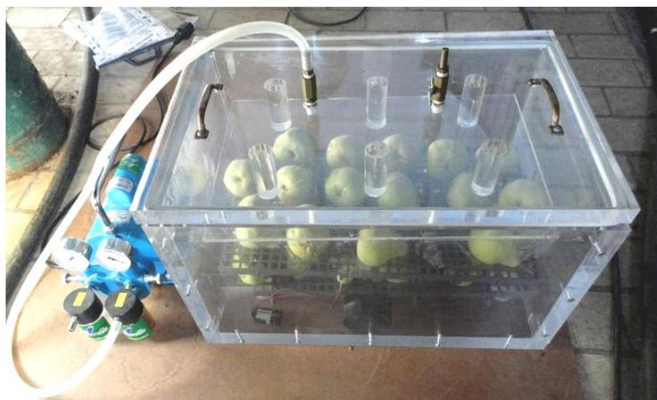
FIGURA 3. Caixa de acrílico conectada a uma bomba de vácuo e provida de ventiladores, contendo as peras ‘Packham’s Triumph’ dispostas sobre estrado modular. Bento Gonçalves, 2011.
