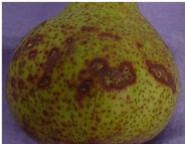
FIGURA 11. Pera 'Packham's Triumph' submetida à rotação de 140 rpm, durante 20 minutos e à detecção de dano mecânico de atrito com TCT 0,1% (p/v) durante 20 horas, em condição de temperatura ambiente simulada ( $30 \pm 2$  °C) e ausência de luz, apresentando halo vermelho intenso na região lesionada e coloração marrom clara no interior da mancha. Bento Gonçalves, 2011.
