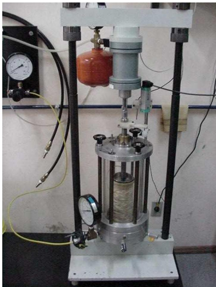
Figura 3.9: Equipamento triaxial para cargas repetidas, Malysz (2004)
