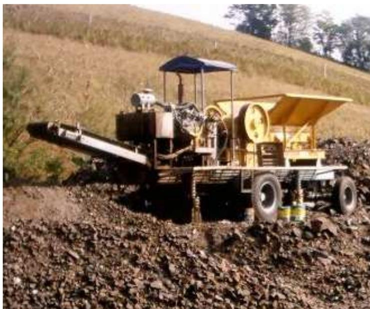
Figura 3.7: Britador móvel da Prefeitura Municipal de Ametista do Sul, equipamento instalado sobre pilha de rejeitos.
