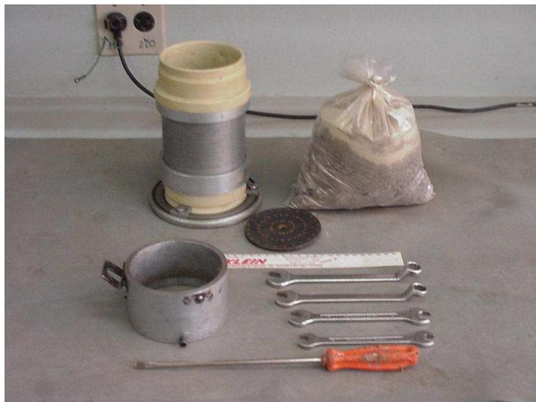
Figura 3.8: Equipamentos para a moldagem dos CPs, Malysz (2004).
