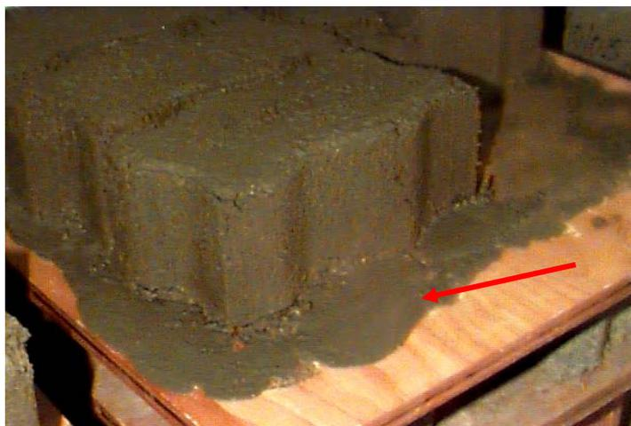
Figura 15: aspecto dos blocos de concreto com H = 7,5% - detalhe para a presença de nata de cimento junto aos moldes
