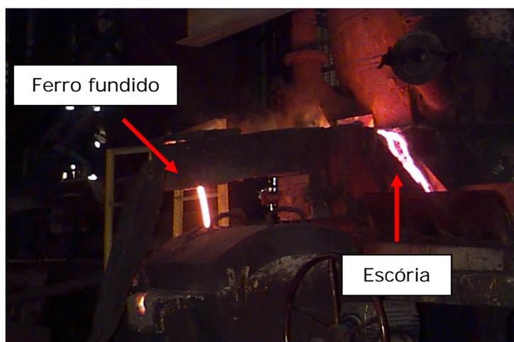
Figura 4: ferro fundido e escória sendo vertidos na lateral do forno cubilô
