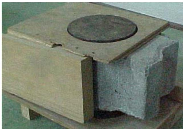
Figura 19: detalhe do gabarito de madeira utilizado junto à prensa
