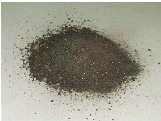
Figura 5: aspecto da escória granulada de fundição após resfriamento
