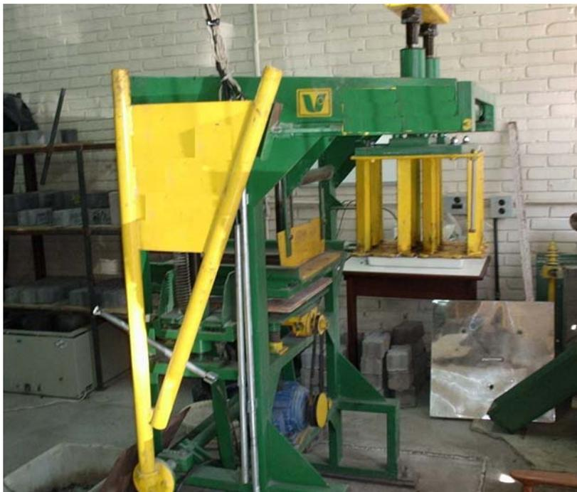
Figura 11: equipamento de vibro-prensagem utilizado na moldagem dos blocos
