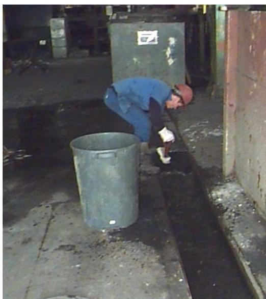
Figura 10: escória sendo retirada do canal após seu resfriamento
