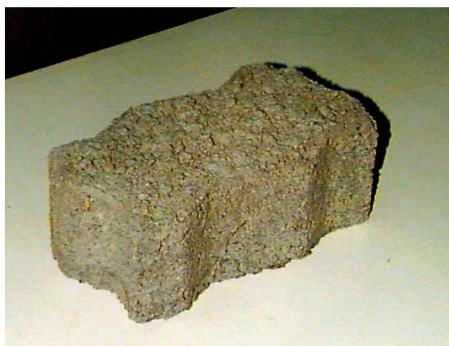
Figura 13: aspecto superficial do bloco de concreto de pavimentação no traço piloto
