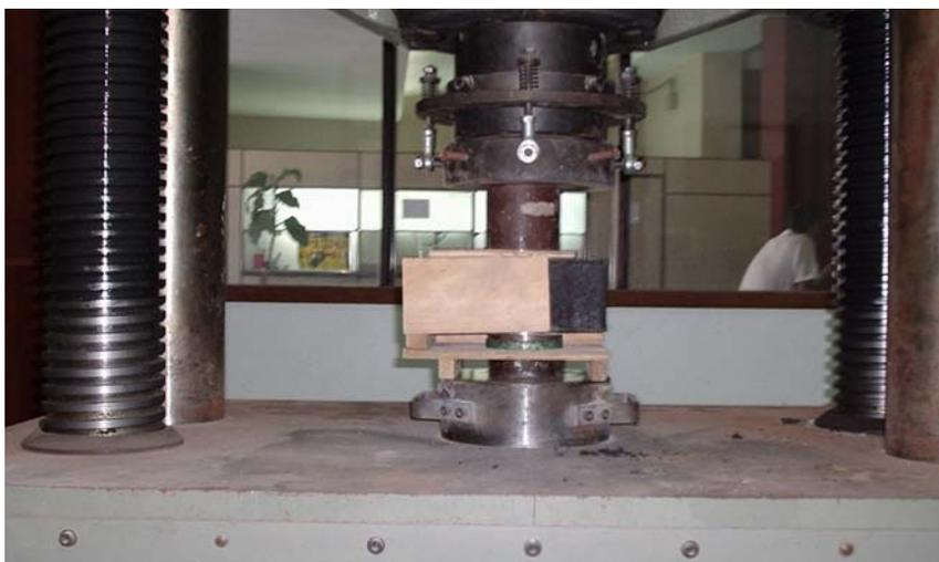
Figura 18: ensaio de resistência à compressão dos blocos
