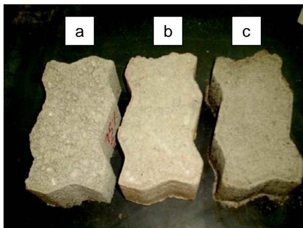
Figura 14: aspecto superficial dos blocos de concreto para pavimentação com teores de argamassa de (a) 75%, (b) 78% e (c) 81%
