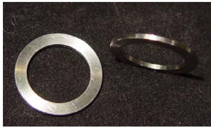
Fig 6. Matriz metálica para confecção dos c.p. de sorção e solubilidade
