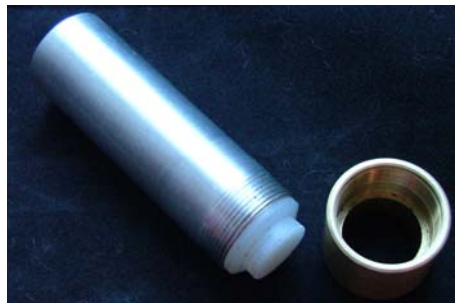
Fig 8. Dispositivo tipo êmbolo para remover os corpos de prova da matriz sem fraturar
