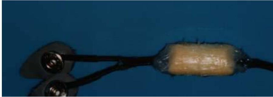
Figura 14: Isolamento do pré-amplificador nos cabos
