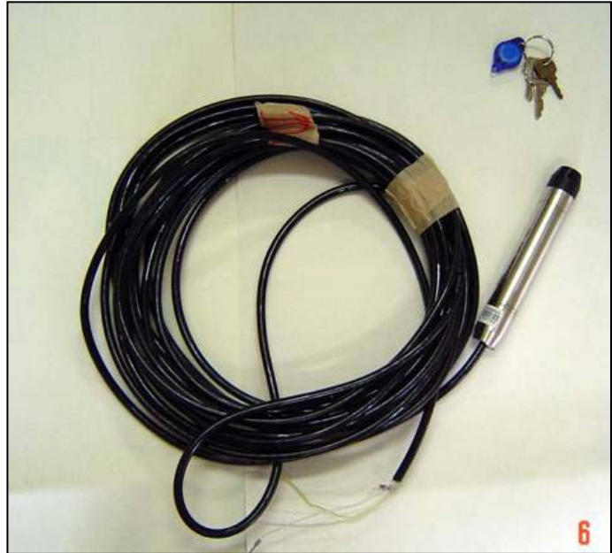
Figura 3.23. Sensor de pressão para medição de coluna d'água.
