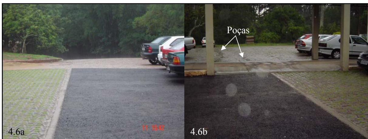
Figura 4.6. Comportamento do pavimento durante evento de precipitação.
